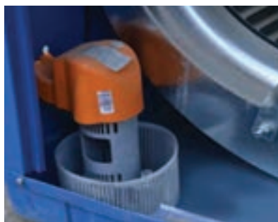
صافی آب و پمپ
