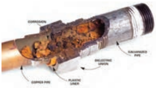
خوردگی زانوی فولادی گالوانیزه در اتصال با لوله مسی
