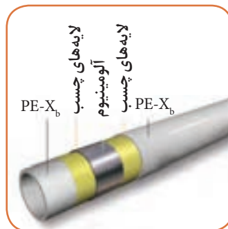
لایه آلومینیوم در لوله پنج لایه
