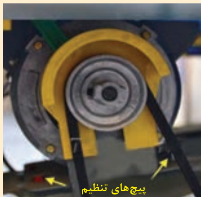
پیچ‌های تنظیم موتور
