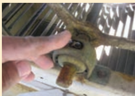
محل روغن کاری یاتاقان
