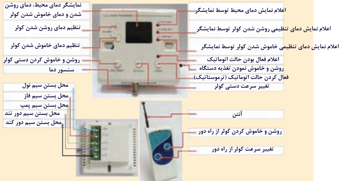
مدار کلید هوشمند کولر آبی
