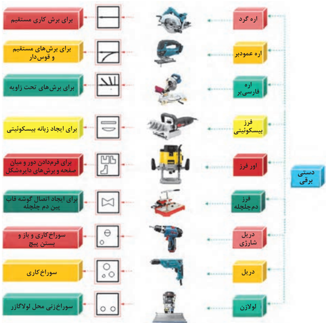
شکل ۱۲۰-۱ - دسته بندی ابزارهای دستی برق
