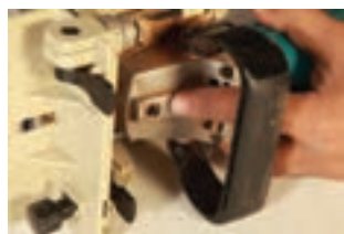
شکل ۱-۱۸۳-ب - روش تعویض تیغه
