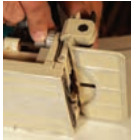
شکل ۱-۱۸۴- تنظیم عمق کنشکاف
