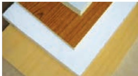
شکل ۱-۴۶- تخته خرده چوب با روکش ملامینه
