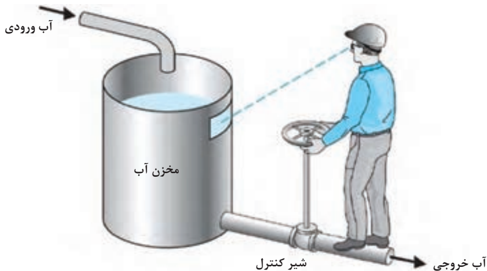
شکل ۱-۵- کنترل دستی ارتفاع آب
