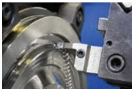
شکل ۶-۴: براده‌برداری به‌وسیله تیغه کاربیدی
