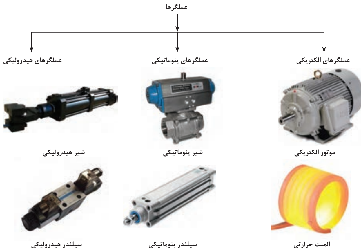
شکل ۲۶-۵. انواع محرک‌ها در سیستم‌های کنترلی
