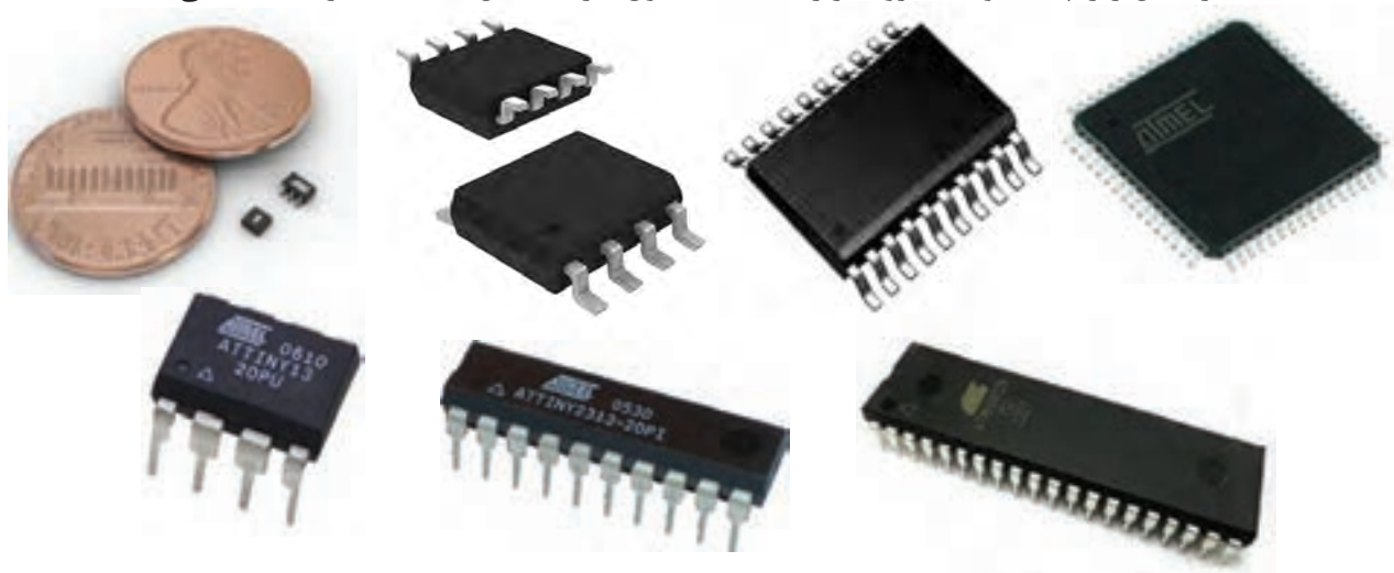
شکل ۲-۲- شکل ظاهری چند نمونه میکروکنترلر AVR، محصول شرکت اتمل (Atmel)
