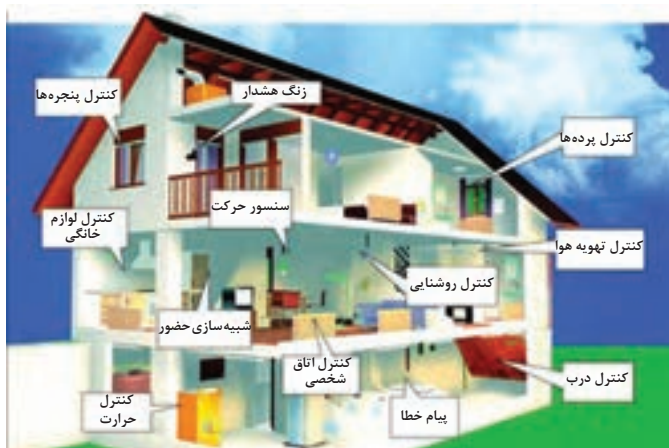
شکل ۲۱-۵- حسگرهای استفاده شده در یک خانه هوشمند
