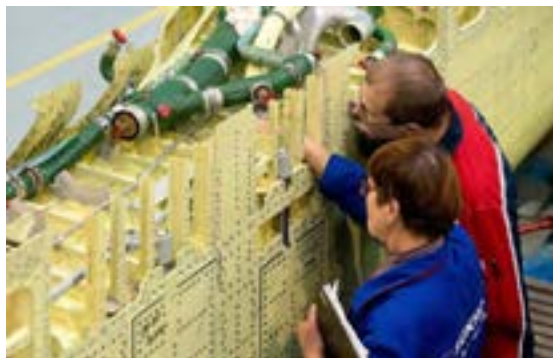
شکل ۳-۱۷ بازدید سازه پرچ کاری شده
