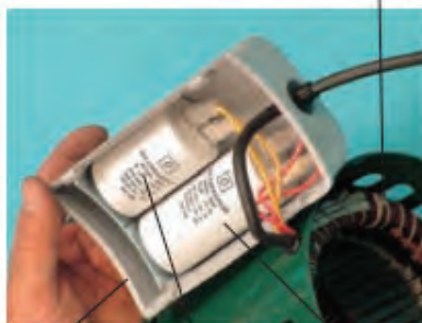
خازن ۱۴ میکروفارادی خازن ۹ میکروفارادی درپوش خازن‌ها سرعت زیاد سرعت کم
