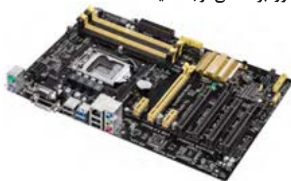
شکل ۸ - برد اصلی با فرم فاکتور ATX
