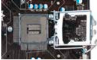
شکل ۹- سوکت پردازنده
