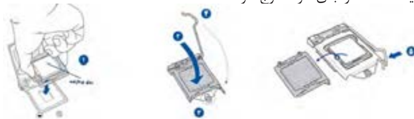
شکل ۳۵- مراحل قراردادن پردازنده در سوکت
