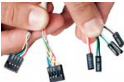
شکل ۴۴- کانکتورهای پنل جلوی کیس
