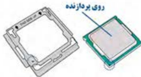
شکل ۳۴- نشانه روی پردازنده و سوکت
