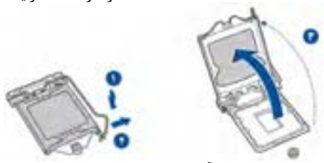
شکل ۳۲- آزاد کردن نگهدارنده سوکت
