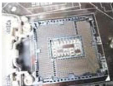
شکل ۳۳- سوکت پردازنده
