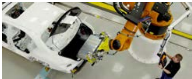
شکل ۶-۱: یک ربات، باک بنزین را در زیر صندوق عقب ماشین نصب می‌کند.
