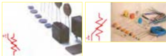
شکل ۹۵-۱- چند نمونه مقاومت‌های تابع حرارت و نماد آن
