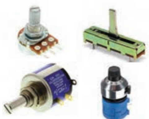
شکل ۹۴-۱- چند نمونه مقاومت‌های متغیر معمولی با محور دوار و کشویی
