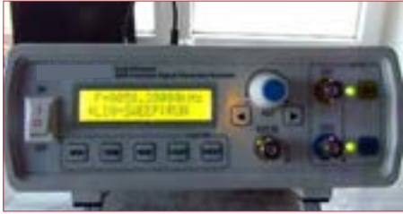
شکل ۲-۴۴- دو نمونه دستگاه سیگنال ژنراتور
