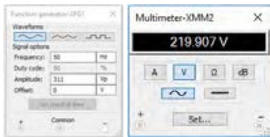
شکل ۲۷ - ۳ - شبیه‌سازی ولتاژ برق شهر
