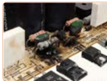
شکل ۲۳-۴ - آسیب قطعات در یک برد
