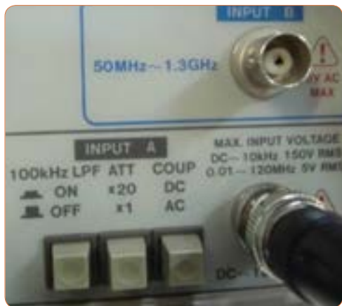
شکل ۳۷-۳- ورودی‌های فرکانس متر دیجیتالی
