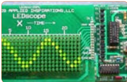
شکل ۴۳-۳- یک نمونه اسیلوسکوپ با صفحه‌نمایش LED
