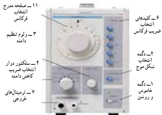
شکل ۲۲-۳ یک نمونه سیگنال ژنراتور
