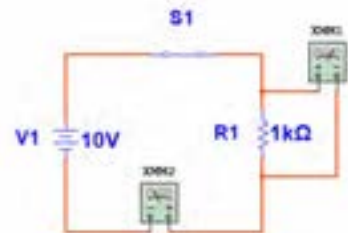
شکل ۲۰ - ۴ مدار آزمایش با آمپرمتر
