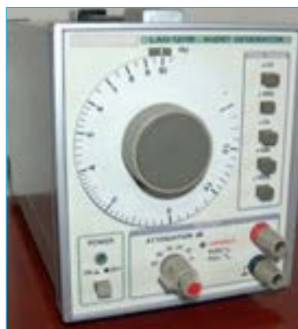
۳-۲۰- سیگنال ژنراتور با کلیدها و سلکتورهای مکانیکی
