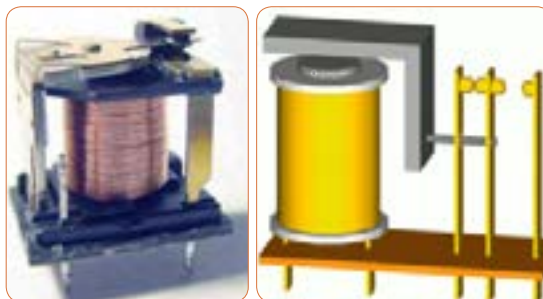
شکل ۳۴-۵. ساختمان داخلی دو نوع رله
