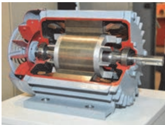
شکل ۱۳- موتور القایی سه فاز
