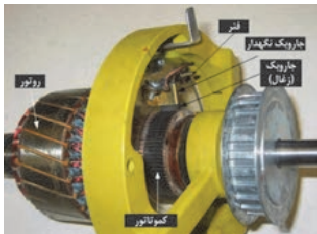
شکل ۸- جاروبک و جاروبک نگهدار
