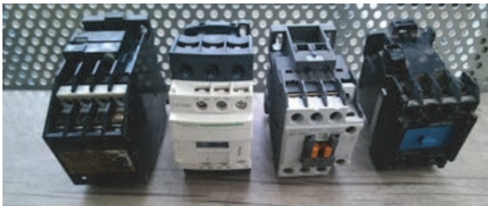
شکل ۹- کنتاکتور
