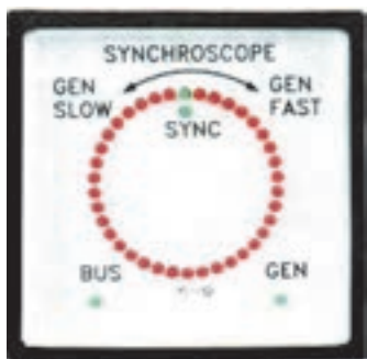
شکل ۱۳- سنکروسکوپ و مدار یک سنکروسکوپ ساده
