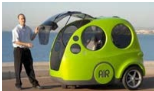
استفاده از باد فشرده در حرکت خودروی بادی
