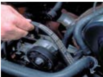
۵- تسمه بر روی پولی‌ها و هرزگرد‌ها مطابق دستورالعمل نصب شود.
