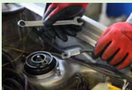
شکل ۳۳-۱- جداکردن اتصالات منفی بدنه
