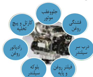
شکل ۵-۳- نقاط احتمالی بروز نشستی موتور
