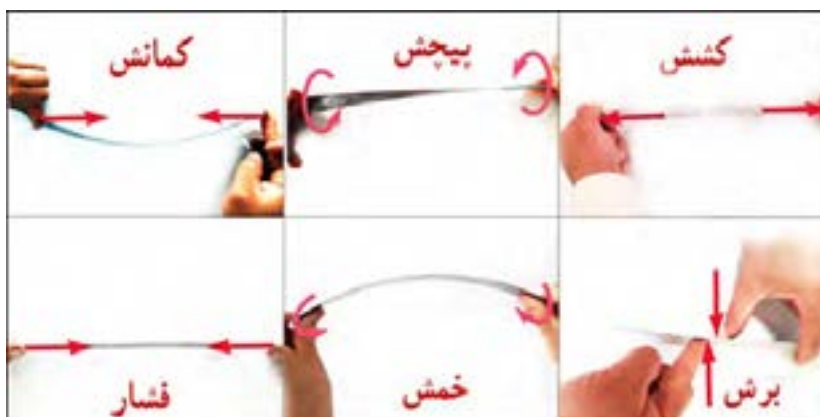
شکل ۴-۶- انواع بارگذاری روی خط کش فلزی
