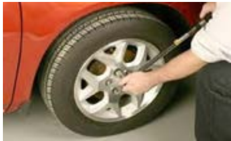
شکل ۴-۵- گشتاور لازم برای سفت کردن چرخ
