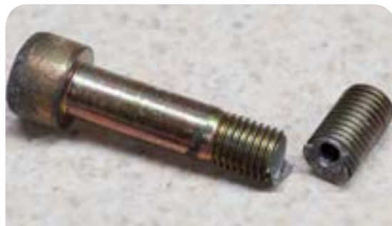
شکل ۳۱-۶- یک پیچ بریده شده بر اثر بارگذاری پیچشی
