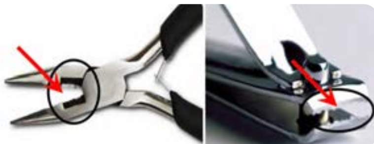
شکل ۱۹-۶- لبه‌های برنده خراب شده در ناخن گیر و دم باریک
