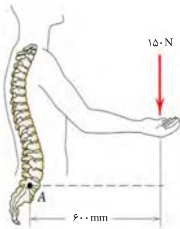
شکل ۹-۶- گشتاور وارده به ستون فقرات بر اثر بلند کردن بار توسط دست ها
