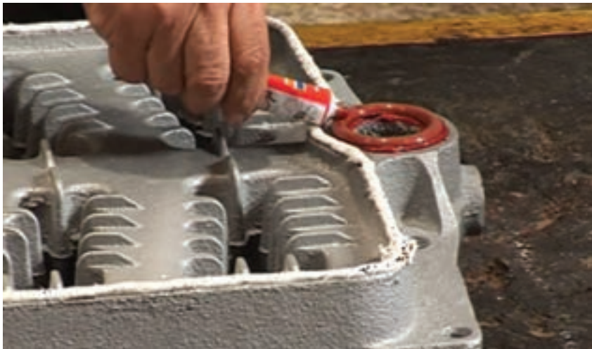
شکل ۲۰- استفاده از اورینگ به جای بوش
