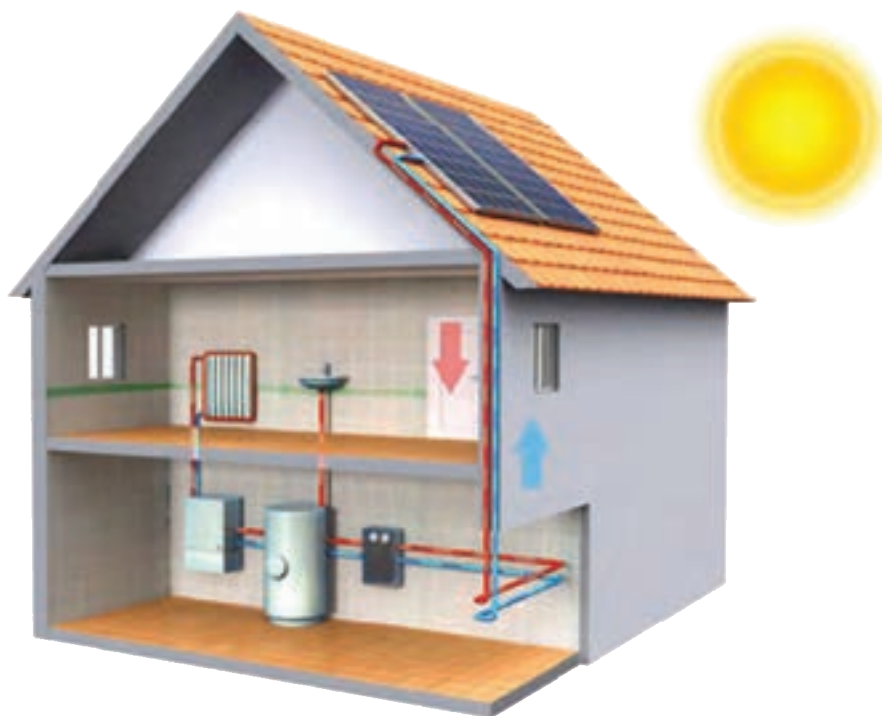
شکل ۳- شماتیک خانه ای با گرمایش و آب گرم مصرفی خورشیدی
