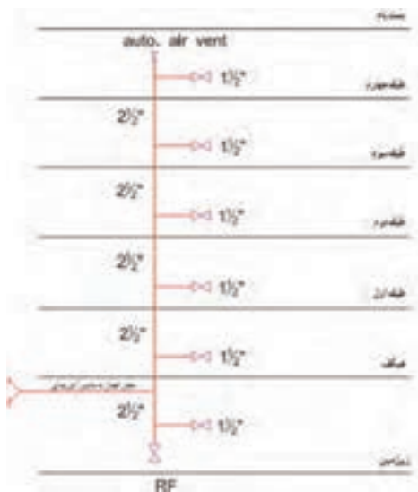
شکل ۲۱- رایزر دیاگرام لوله کشی آتش نشانی خشک
