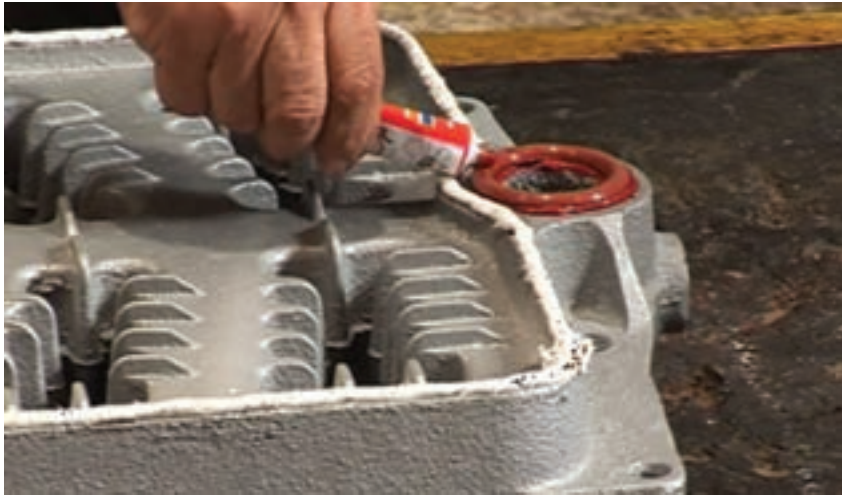
شکل ۲۰- استفاده از اورینگ به جای بوش
