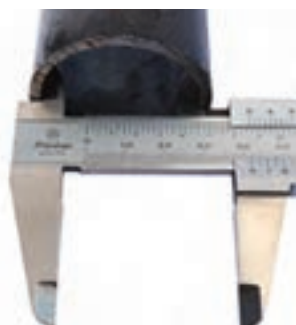
شکل ۴۸ - شاخک‌های داخل‌سنج کولیس
