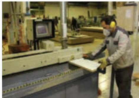
شکل ۷۸- نوار کردن قطعه کار
