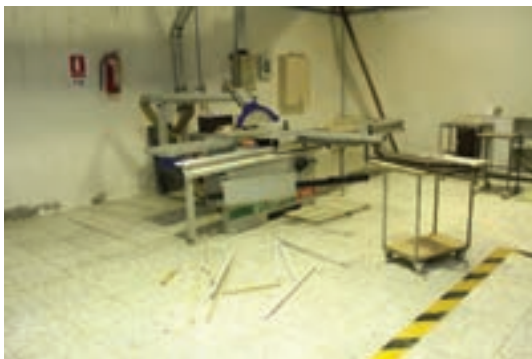
شکل ۷۶- انداختن ضایعات در کف کارگاه
