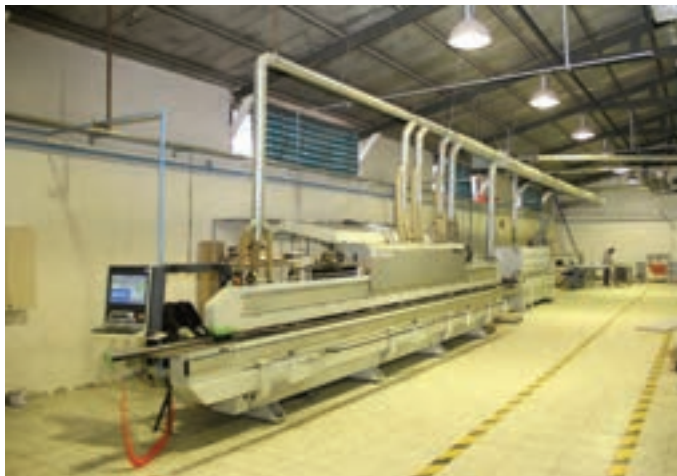
شکل ۱۱- نحوه اتصال مکنده‌های ثابت
