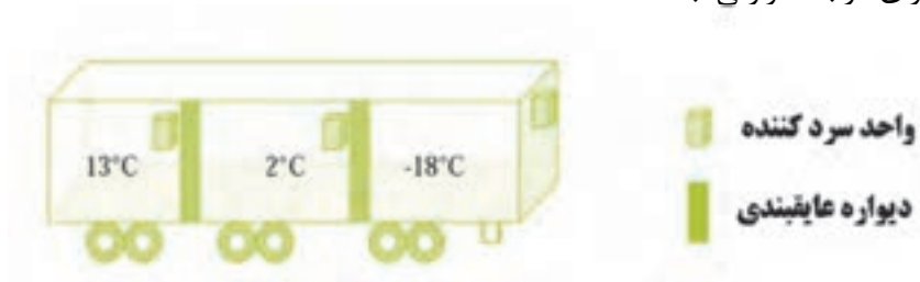
شکل ۲۰- نمای شماتیک از کانتینر با دماهای مختلف پشت سرهم
