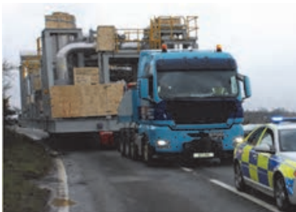
شکل ۱۵- نمونه‌ای از حمل بار مرتفع، عریض، طویل و فوق سنگین با بوژی
