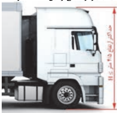
شکل ۴- حداکثر ارتفاع تعیین شده برای وسایل نقلیه
