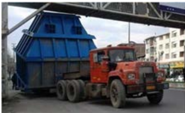
شکل ۱۹- مسیر نامناسب حمل بار ترافیکی
