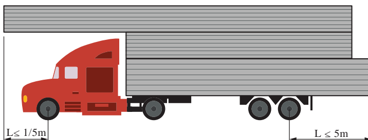
شکل ۳۰- حداکثر میزان تعیین شده بیرون‌ماندگی بار از عقب و جلوآمدگی بار از جلو انواع تریلی
