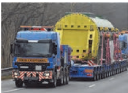
شکل ۱۰- نمونه‌ای از کشنده و یدک (بوژی)
