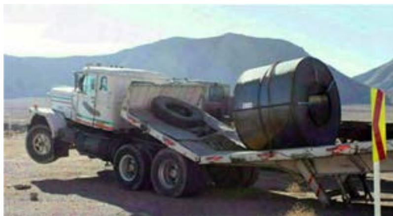
شکل ۲- عدم توزیع مناسب بار بر گروه‌های محوری
