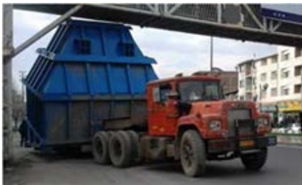
شکل ۱۹- مسیر نامناسب حمل بار ترافیکی
