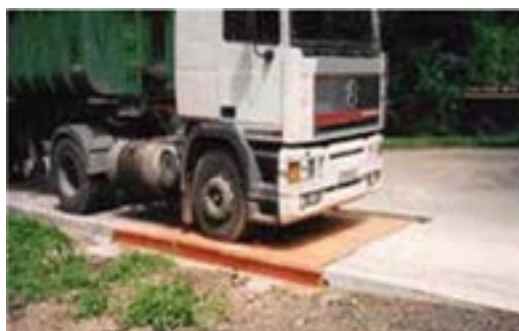
شکل ۳- باسکول محورکش ثابت
