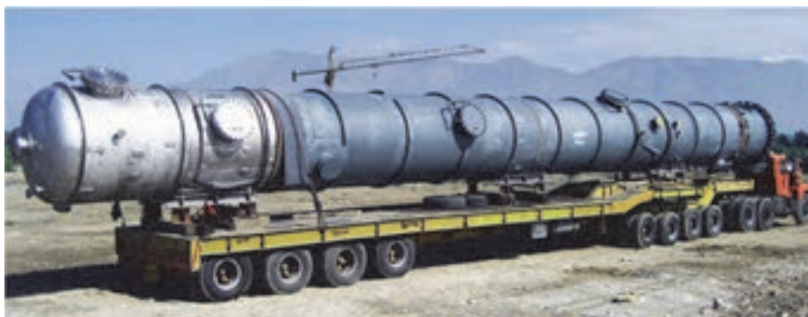
شکل ۱۱- نمونه‌ای از کشنده و نیمه‌یدک (کمرشکن)
