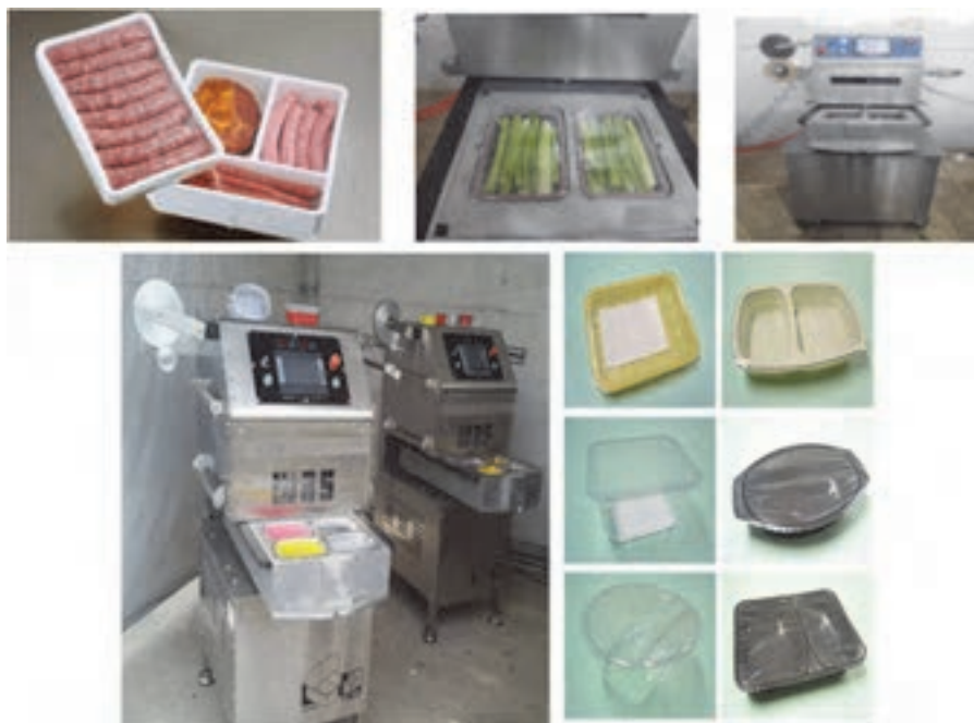
شکل ۳۲- نمونه‌ای از دستگاه‌ها و بسته‌بندی‌های تهیه شده به روش اتمسفر تغییر یافته
