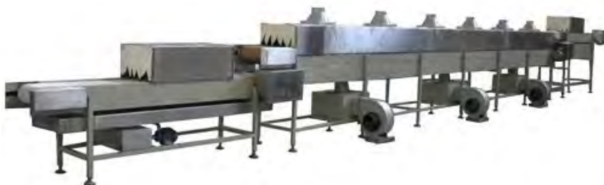
خشک کن نواری با تسمه و استیل به صورت تونلی با هوای گرم و درجه حرارت قابل تنظیم ۵۰ تا ۹۰ درجه سانتی‌گراد
