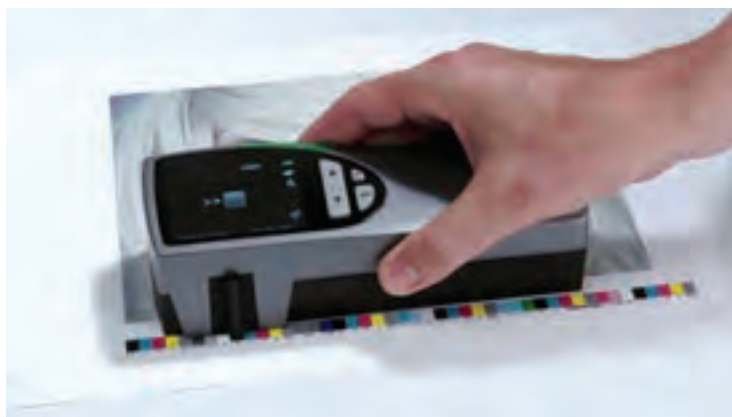
تصویر ۳۸ رنگ‌سنجی بر اساس نوار رنگ با استفاده از دستگاه رنگ‌سنج (Color Meter)
