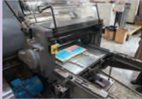
تصویر ۱۰ نصب قالب روی ماشین لترپرس
