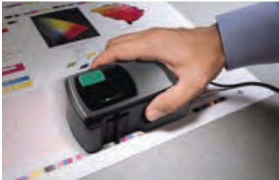
تصویر ۳۳ اندازه گیری نوار رنگ با دستگاه رنگ سنج
