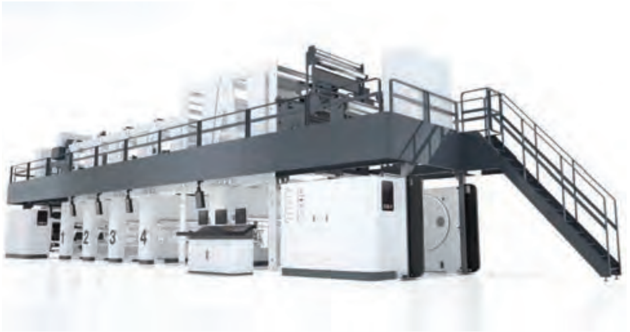
تصویر ۲ دستگاه ماشین چاپ فلکسوگرافی
