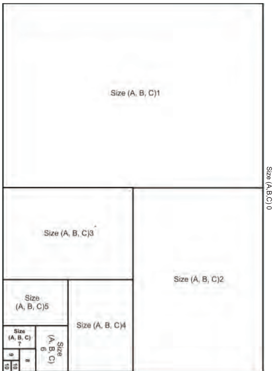
نمودار ۱ چیدمان کاغذها بر اساس استاندارد (ISO216)
