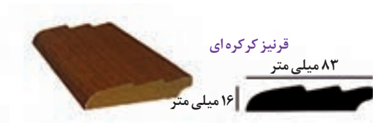
شکل ۸۱ - چند نمونه از قرنیزهایی که درمحل اتصال کف پوش لمینت به سطوح مجاور به کار می رود.
