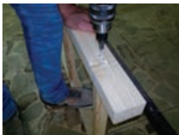
شکل ۵۴- سوراخ کاری جای پیچ دوم
