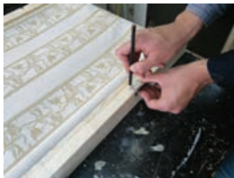
شکل ۶۸- خط کشی با استفاده از لولا
