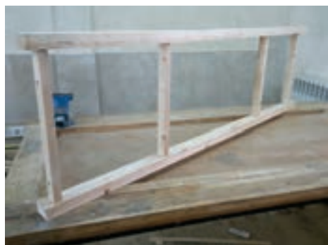
شکل ۵۲- اتصال موقت قطعات پاراوان
