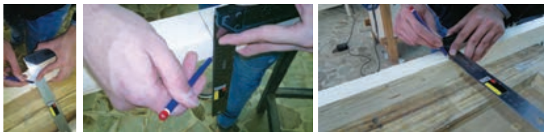
شکل ۴۵- انتقال اندازه‌ها به قطعه دوم
