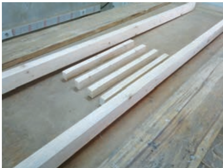
شکل ۳۹- قطعات پاراوان (۲ قید طولی و ۴ قید عرضی)
