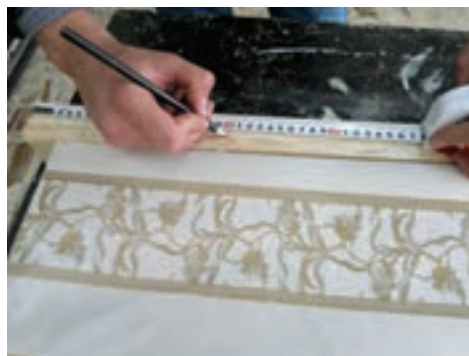
شکل ۶۶- اندازه گیری محل لولا
