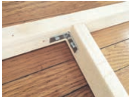
شکل ۲۱- اتصال با بست گونیایی
