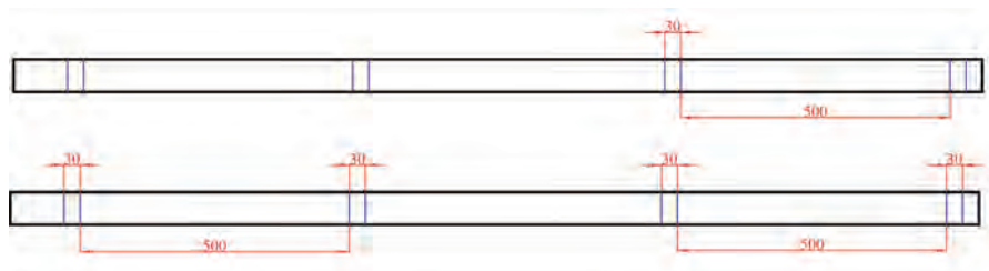
شکل ۴۳- ترسیم کامل خطوط محل قرارگیری قیدهای افقی بر روی قید طولی
