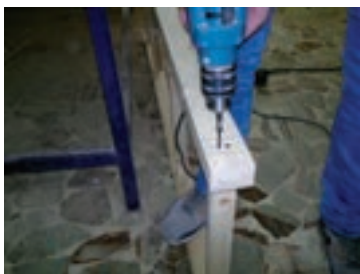
شکل ۵۷- بستن پیچ با دریل
