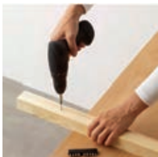
شکل ۳۱- بستن پیچ
