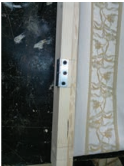
شکل ۷۲- محکم کردن برگه اول لولا با ۳ پیچ
