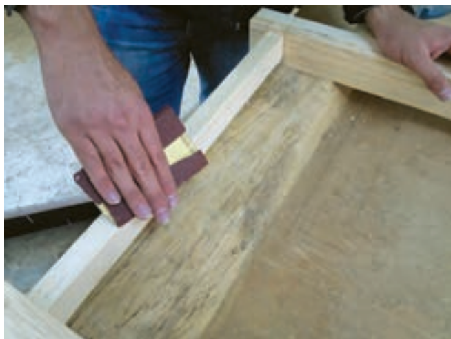
شکل ۶۰- سنباده زدن و گرفتن تیزی لبه‌ها
