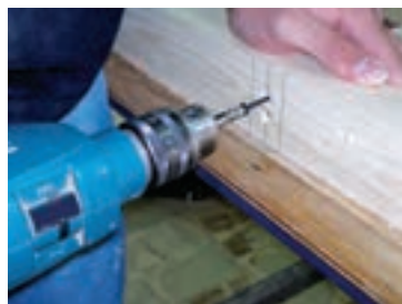
شکل ۵۸- بستن پیچ در حالت افقی
