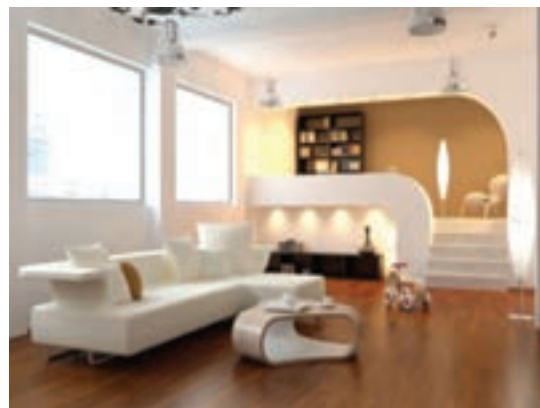
شکل ۲-۴۱ و شکل ۲-۴۲- اختلاف سطح در بین فضاهای داخلی به تفکیک قلمروها کمک می‌کند و اشراف بخش بالاتر به پائین‌تر را سبب می‌شود.
