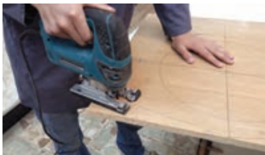
شکل ۵۲- برش حاشیه مورب پایه‌ها
