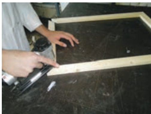
شکل ۲۷-منگنه زدن گوشه‌های دیگر قاب
