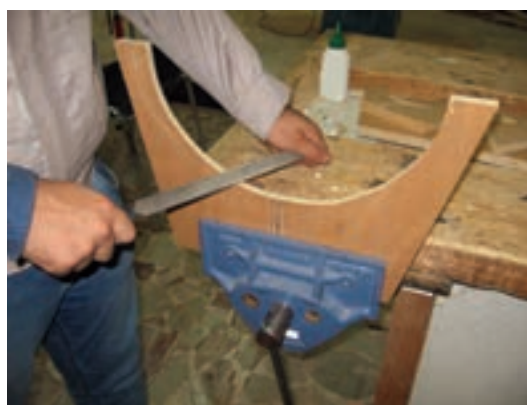
شکل ۶۳- پرداخت با چوبسای زبر
