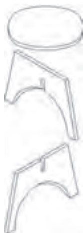
شکل ۳۰- نقشه انفجاری چهارپایه
