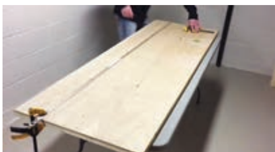
شکل ۴۶- بستن خط کش با گیره
