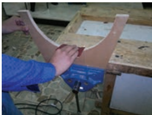
شکل ۶۵- سنباده کاری با دست
