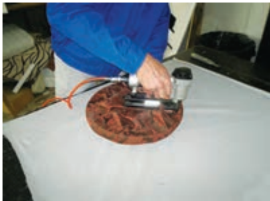
شکل ۱۱۸- منگنه کاری دورها
