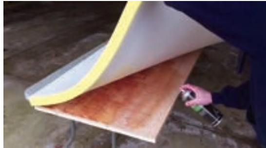
شکل ۵۲- چسب زدن روی تخته
