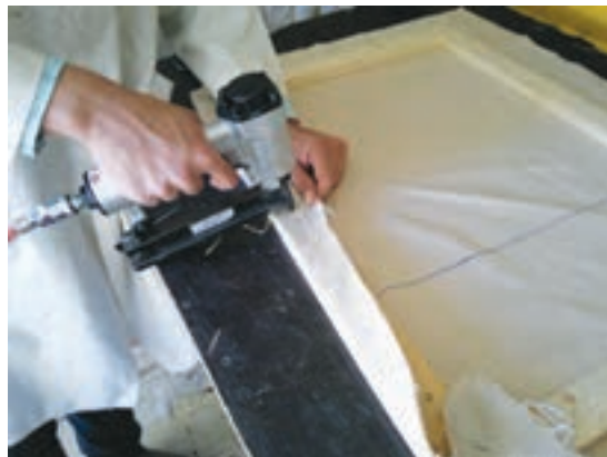
شکل ۳۳- منگنه زدن وسط قاب
