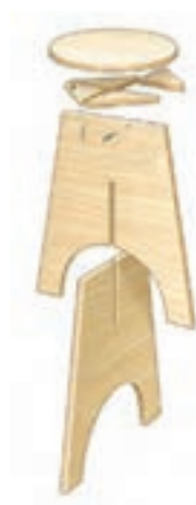
شکل ۳۰- نقشه انفجاری چهارپایه
