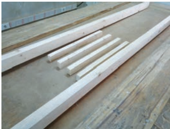
شکل ۳۹- قطعات پاراوان (۲ قید طولی و ۴ قید عرضی)
