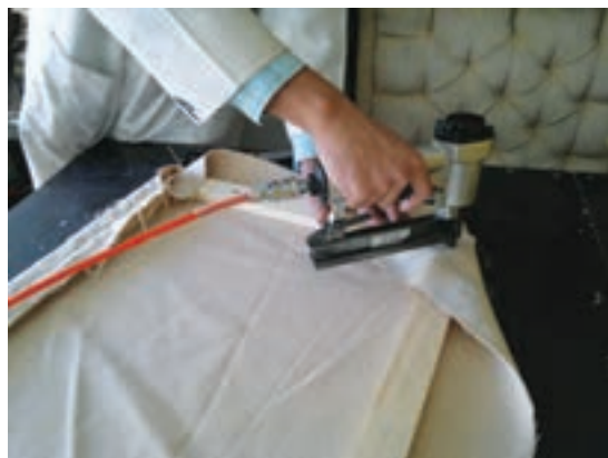
شکل ۳۵- منگنه زدن یک گوشه دیگر
