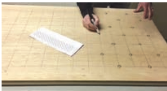
شکل ۴۸- علامت گذاری محل سوراخ‌ها با ماژیک
