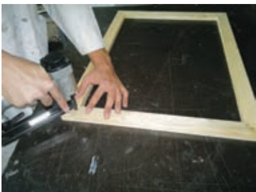
شکل ۲۸-منگنه زدن پشت قاب
