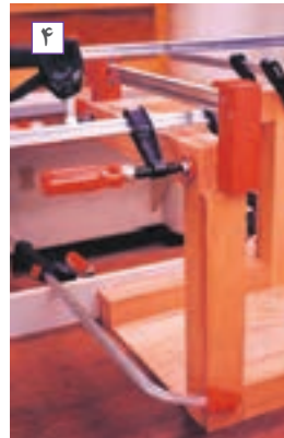
شکل ۲۷- مراحل مونتاژ میز جلوی مبل
