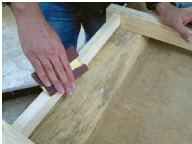
شکل ۶۰- سنباده زدن و گرفتن تیزی لبه‌ها
