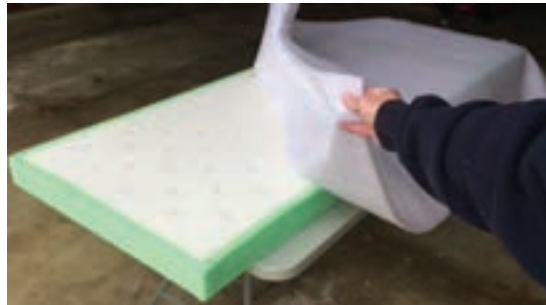
شکل ۶۰- پوشش اسفنج با یک لایه گان
