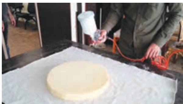
شکل ۸۷- پاشیدن چسب با پیستوله
