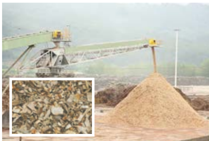
(۴) تبدیل به تکه‌های ریز چوب (چیپس چوب)
