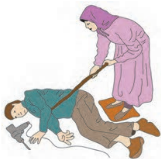
شکل ۸- نحوه صحیح جدا کردن فرد از برق
