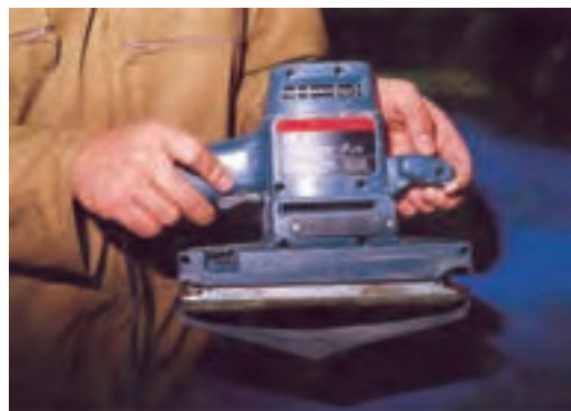
شکل ۷-۴۶- شل و سفت بستن سنباده شدن سنباده به دستگاه.
