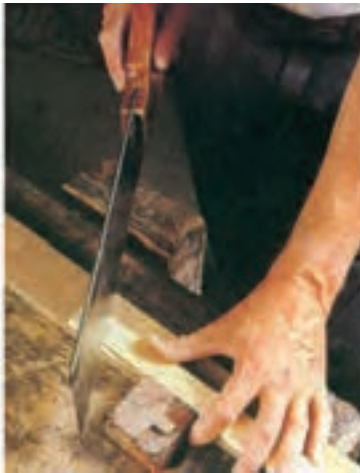
شکل ۱۱-۱۰- برش زهوار، با زاویه‌ی ۴۵ درجه.
