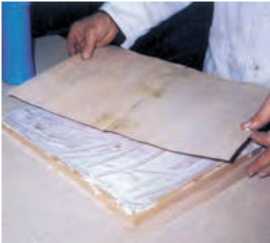
شکل ۶-۱۷- پس از چسب‌کاری صفحه‌ی مصنوعی، روکش آماده را روی آن قرار دهید.
