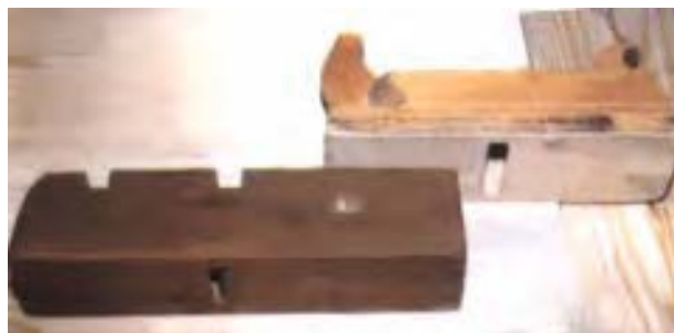
شکل ۱۷-۲- پس از پایان کار، رنده‌ها به پهلو فوابانده شود.
