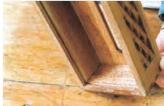
شکل ۹-۶۷- کنشکاف داخل بدنه‌های یک جعبه دستمال کاغذی.
