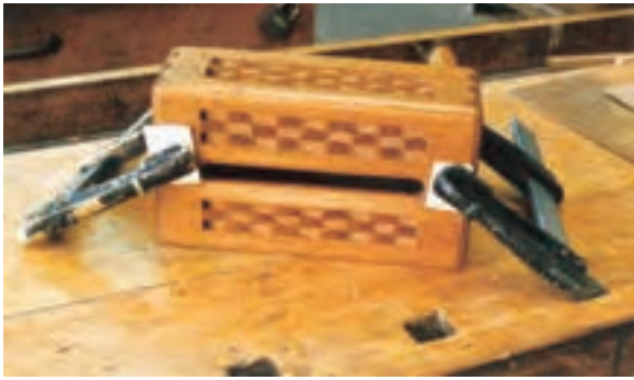
شکل ۹-۷۰- بستن سقف به بدنه‌ها.
