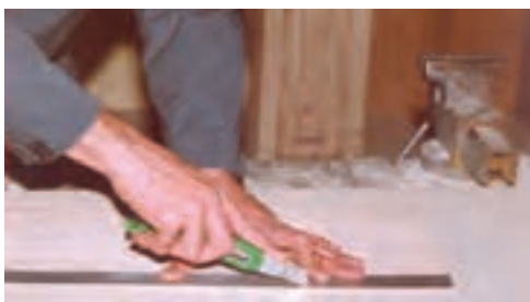
شکل ۵-۲۹- برش (روکش با کاتر)
