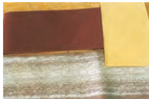
شکل ۲۶-۷. سنباده فراب و غیر قابل استفاده در مقابل سنباده‌های سالم.
