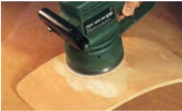
شکل ۲۷-۷. هنگام تعویض ورق سنباده باید دو شاخه دستگاه را از پریز فابج کنید.
