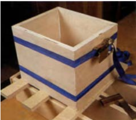
شکل ۱۴۸-۱- از گیره‌ی تسمه‌ای می‌توان برای چسباندن بدنه‌های صندوق مکعبی نیز استفاده کرد. با توجه به ارتفاع آن، می‌توان ۲ تسمه یا بیشتر به‌کار برد.
