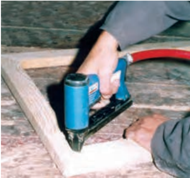
شکل ۱۶-۸. منگنه زدن روی درزهای ۴۵ درجه شده.
