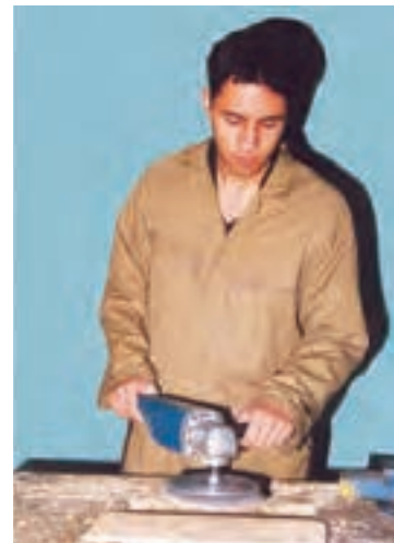
شکل ۷-۴۰- هدایت و کنترل صمغ دستگاه سنباده.
