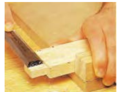
شکل ۹۹۸- اندازه کردن زبانه با مغار.
