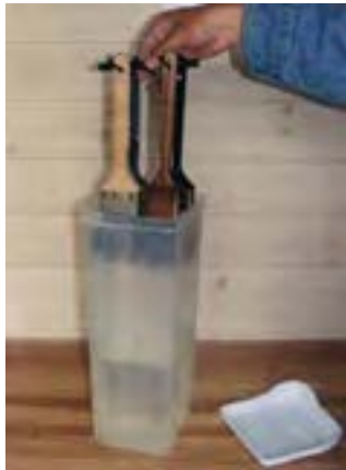
شکل ۴-۴۱- قلم‌موها را پس از تمیز شدن، داخل قوطی ماوی نفت یا تینر قرار دهید.
