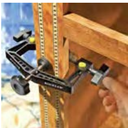
شکل ۱-۱۴۰- برای چسباندن زهوار، باید از گیره‌های مخصوص لبه چسبانی استفاده کرد.
