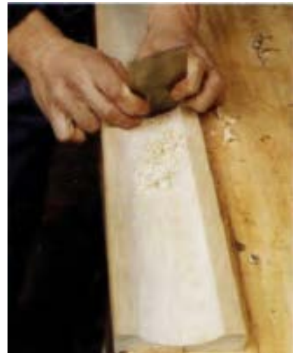
شکل ۲-۵- کاربرد لیسه با لبه‌ی نیمه گرد.
