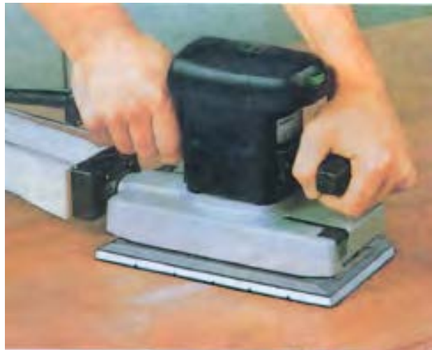
شکل ۳-۱۴- سنباده‌زنی با یک دستگاه سنباده لرزان کامل.
