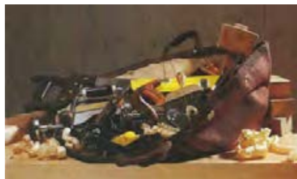
شکل ۱۶-۲- ریفتن ابزارها روی هم، علاوه بر کاهش تیزی، از دقت آنها نیز می‌کاهد.
