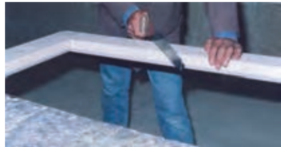
شکل ۱۱-۲۶- ایجاد شیار با اره‌ی دستی.
