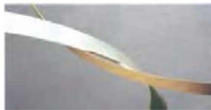
شکل ۵-۲۳- نوار پی وی سی، انعطاف بسیار بالایی دارد.
