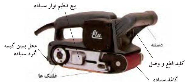
شکل ۷-۵- اجزای مهم و کاربردی دستگاه سنباده نواری.
