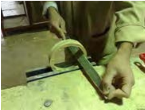
شکل ۱۹۳-۱۲. پرداخت ملقه‌ی چوبی.
