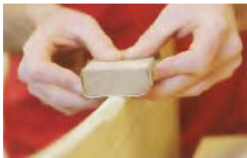
شکل ۳-۲۱. طریقه‌ی سنباده‌کاری نر قطعات با دو دست.
