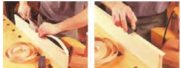
شکل ۱۴۴-۱- برای چسباندن لب‌چسبان‌هایی از جنس روکش طبیعی یا مصنوعی، می‌توان از اتو استفاده کرد.
