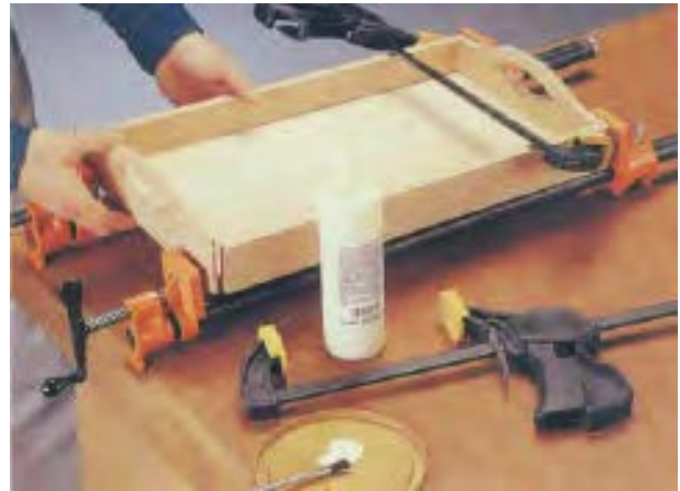
شکل ۱۴۳-۱- برای چسباندن قطعات بزرگ، می‌توان از تنگ دستی استفاده نمود.
