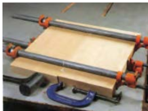
شکل ۱-۳۸- برای چسباندن قطعات چوبی عریض، ضمن زدن رنده‌ی فشی به لبه‌های درز، باید از تنگ مناسب استفاده نمود.
