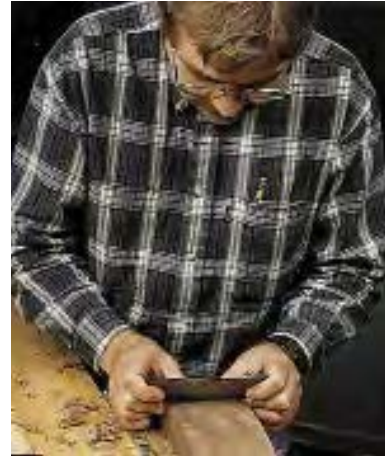
شکل ۲-۳۰- پرداخت سطوح قوس دار به وسیله لیسه.
