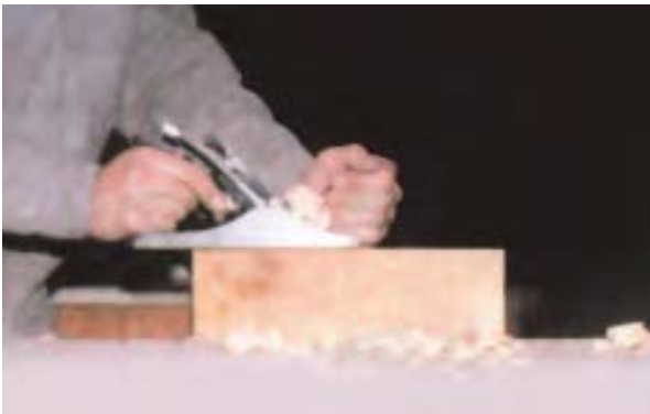
شکل ۲-۲۳- رندیدن سر چوب، به کمک دو قطعه چوب کمکی.
