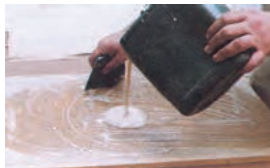
شکل ۴-۶- پفش کردن چسب به وسیله‌ی شانه‌ی چسب‌زنی.
