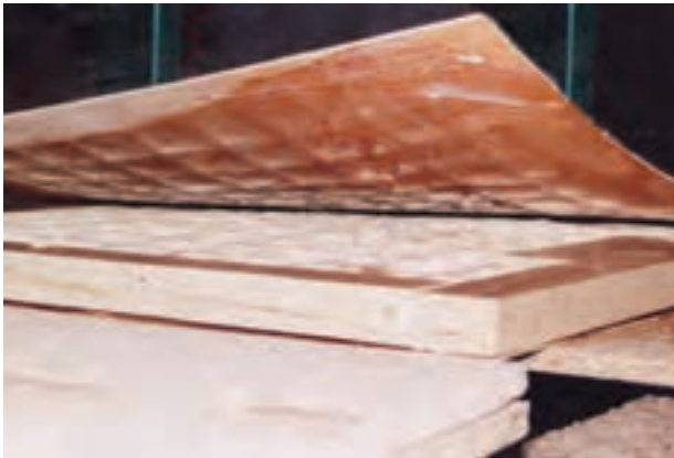
شکل ۱۱-۳۷- قرار دادن صفحه‌ی دوم، روی کلاف.
