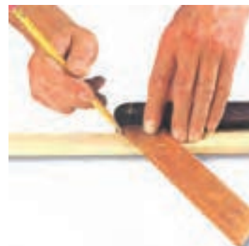
شکل ۱۰-۱۰- فطاکشی زهوار، با زاویه‌ی ۴۵ درجه.
