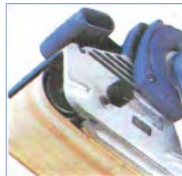
شکل ۷-۴- با این پیچ می‌توان غلتک جلو را حرکت داد.
