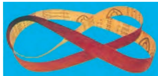
شکل ۲۵-۷. انواع ورق‌های سنباده از نظر شکل ظاهری.
