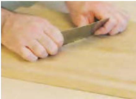
شکل ۲-۱۳- جهت حرکت لیسه، هنگام پُرزگیری.
