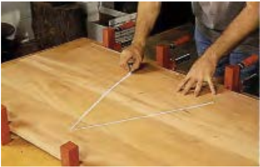
شکل ۱۴۷-۱- تخته‌های درز شده را باید کنار هم روی تنگ‌ها قرار داد و علامت مثلث (Δ) را روی آن ترسیم کرد؛ سپس باید آنها را چسب زد، در جای خود قرار داد و تنگ‌ها را محکم نمود.
