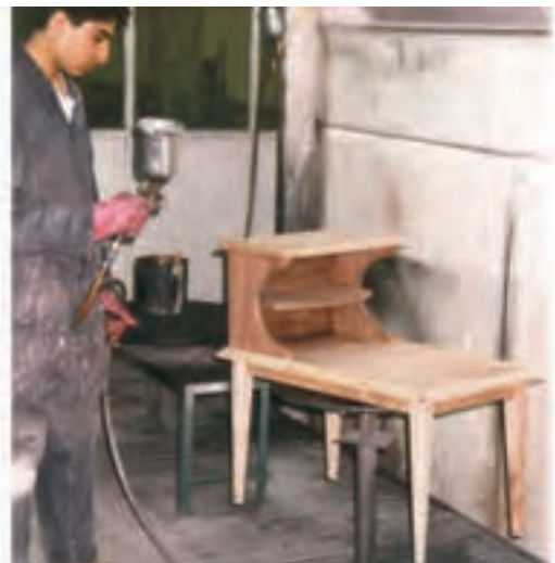
شکل ۲۴-۴. رنگ‌کاری با پیستوله (رنگ شفاف).
