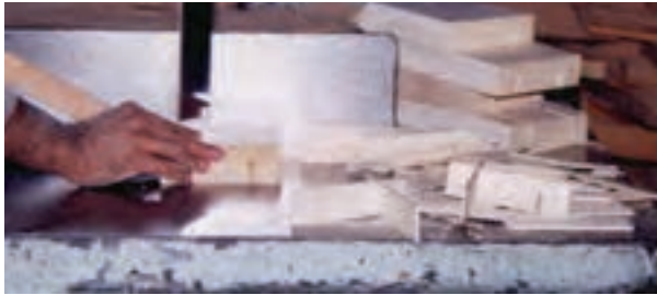
شکل ۱۱-۳۱- تولید شبکه‌های داخل در.
