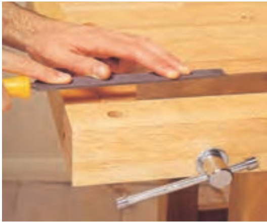
شکل ۲-۷- نمونه‌ی سوهان زدن ضخامت لیسه.
