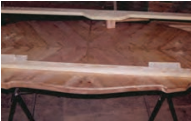
شکل ۱۱-۳۲- کلاف آماده شده برای شبکه‌ریزی.
