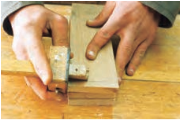
شکل ۹-۶۴- فم کشی تقسیمات فاق و زبانه با فم کش تیره‌دار.
