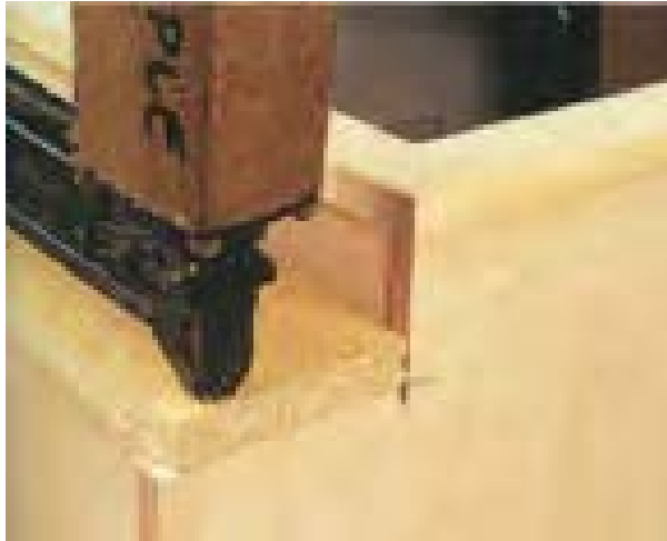
شکل ۲۰-۸- اتصال تخته خرده چوب به کابینت.
