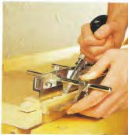
شکل ۹۱۰۰- شیار انداختن داخل قیده‌های عرضی.
