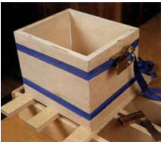
شکل ۱۴۸- از گیره‌ی تسمه‌ای می‌توان برای چسباندن بدنه‌های صندوق مکعبی نیز استفاده کرد. با توجه به ارتفاع آن، می‌توان ۲ تسمه یا بیشتر به‌کار برد.
