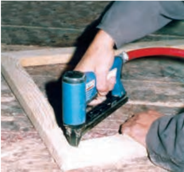
شکل ۱۶-۸. منگنه زدن روی درزهای ۴۵ درجه شده.
