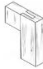
شکل ۱۱-۱۵- فاق و زبانه‌ی یک‌رو مخفی.
