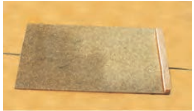
شکل ۹-۶۲- پسباندن زهوار به لبه‌ی کف جعبه.
