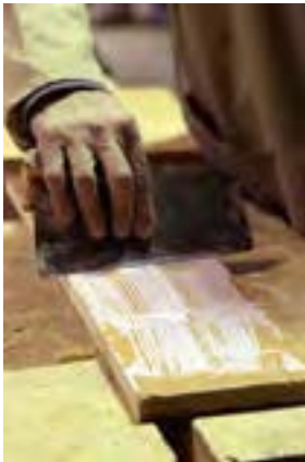
شکل ۱۴-۶- شانه‌ی چسب‌زنی معمولی (کاردک) که با دست روی صفحه‌ی کار هدایت می‌شود.
