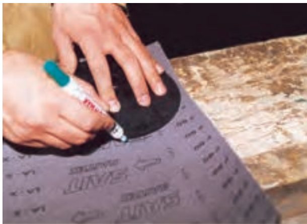
شکل ۷-۳۵- ترسیم گردی دیسک روی سنباده.
