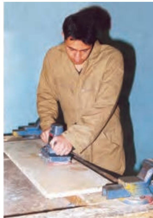
شکل ۷-۱۰. پیچونگی کنترل دستگاه سنباده لرزان.
