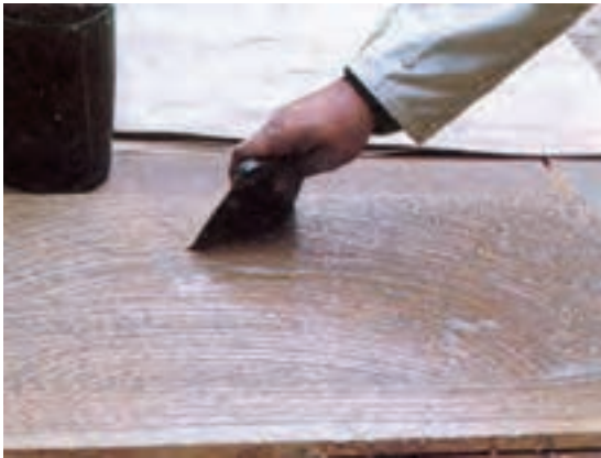
شکل ۶-۱۶- چسب را به وسیله‌ی شانه، روی صفحه‌ی مصنوعی پخش کنید.
