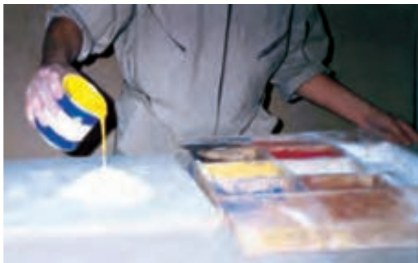
شکل ۴-۳- مواد تشکیل دهنده‌ی بتونه (روغنی).
