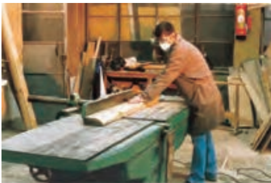
شکل ۹-۹- مقدار باز بودن زیاد گونیا، فطرآفرین است.
