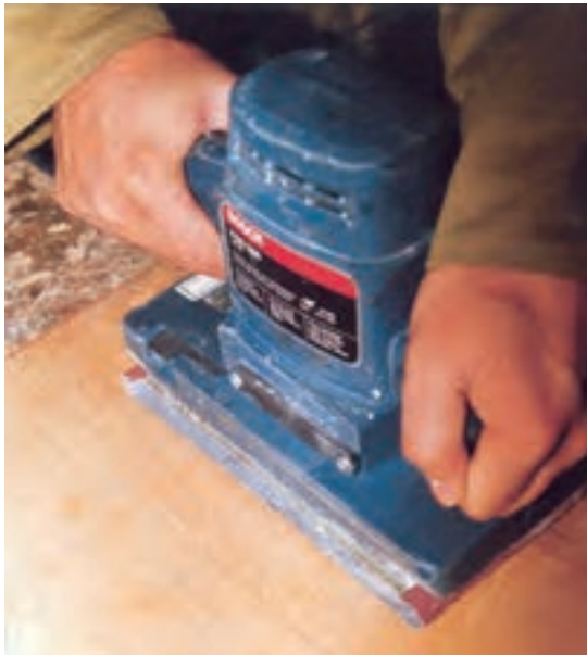
شکل ۷-۱۱. سنباده کاری در جهت الیاف.
