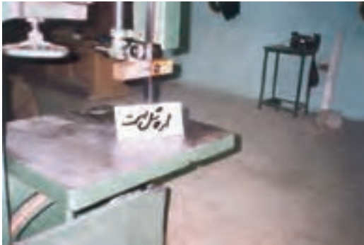
شکل ۹-۵- وقتی تیغه اره شل است، مدام از تابلوی مربوطه استفاده کنید.
