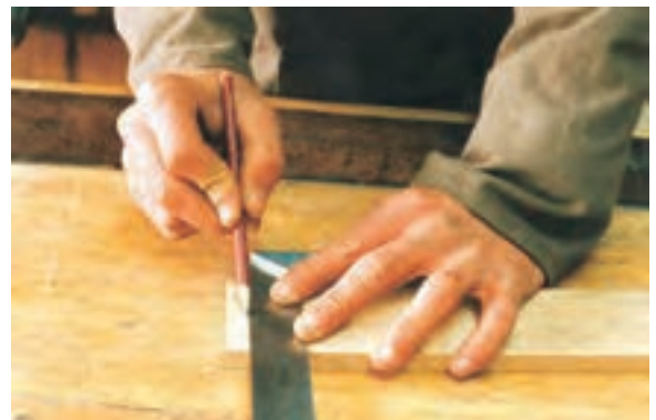
شکل ۹-۶۳- فم کشی ممل اتصال با گونیا.
