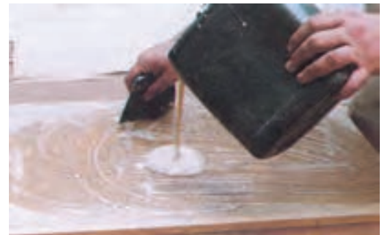
شکل ۶-۶- پفش کردن چسب به وسیله‌ی شانه‌ی چسب‌زنی.
