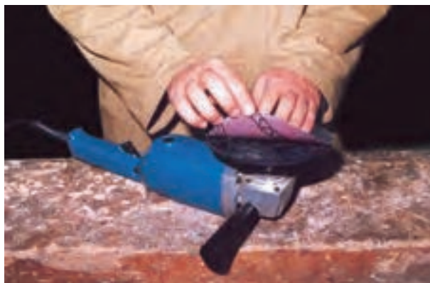
شکل ۷-۳۷- ورق سنباده به دقت روی دیسک قرار گیرد.
