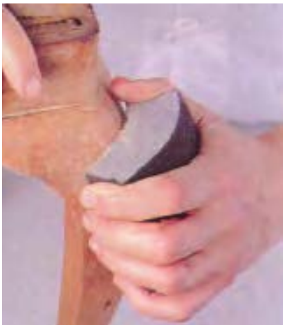
شکل ۳-۲۶- سنباده کاری قوس یک پایه‌ی سم آهویی.
