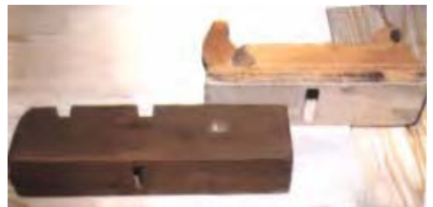
شکل ۱۷-۲- پس از پایان کار، رنده‌ها به پهلو فوابانده شود.
