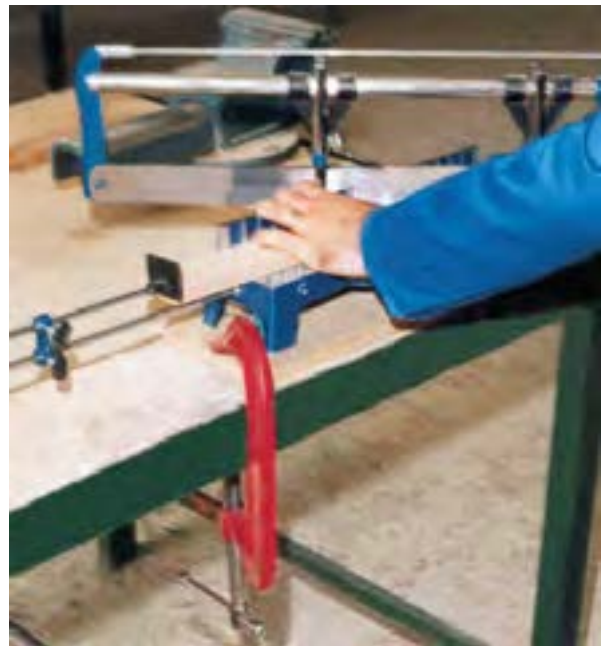
شکل ۱۴-۸. ایجاد برش ۴۵ درجه در گوشه‌های قیدهای قاب، به وسیله اره فارسی بر دستی.
