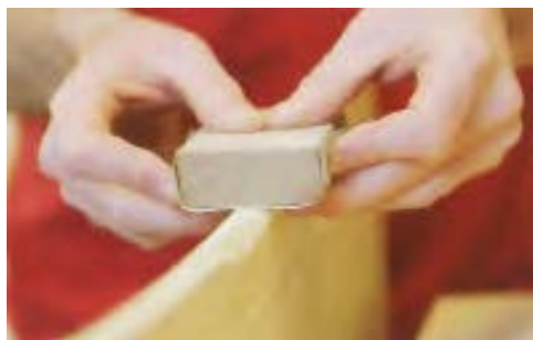
شکل ۳-۲۱. طریقه‌ی سنباده‌کاری نر قطعات با دو دست.
