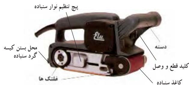
شکل ۷-۵- اجزای مهم و کاربردی دستگاه سنباده نواری.
