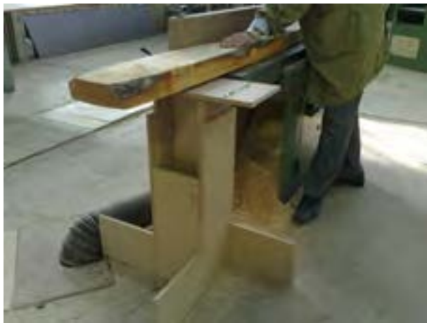
شکل ۹-۱۴- کاربرد میز کمکی برای ماشین کفرند.
