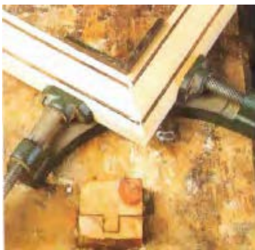
شکل ۱-۱۴۲- برای چسباندن گوشه‌های فارسی قاب، می‌توان از گیره‌ی مخصوص گوشه با فک ۹۰ درجه استفاده کرد.
