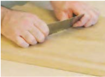
شکل ۲-۱۳- جهت حرکت لیسه، هنگام پُرزگیری.
