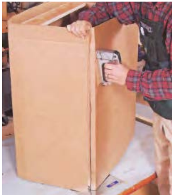
شکل ۲۲-۸. کاربرد منگنه‌ی دستی در بسته‌بندی کالاها.
