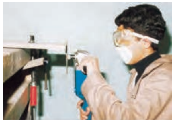
شکل ۷-۴۳- سنبناده کاری قسمت‌های باریک به مهارت و تسلط کافی در کار نیاز دارد.
