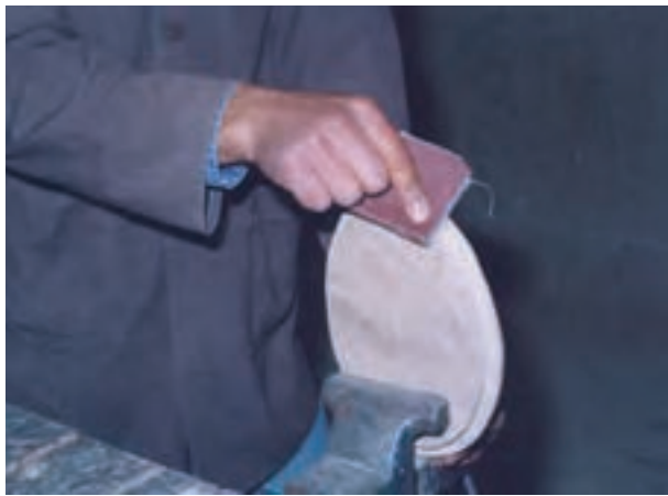
شکل ۳-۱۲. با سفت کردن گیره‌ی بالا، آج (روی فک‌ها، به قطعه کار آسیب می‌رساند.
