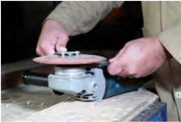
شکل ۷-۲۰- بستن ورق سنباده روی دیسک لاستیکی و ممتک کردن آن با مهره‌ی مخصوص.
