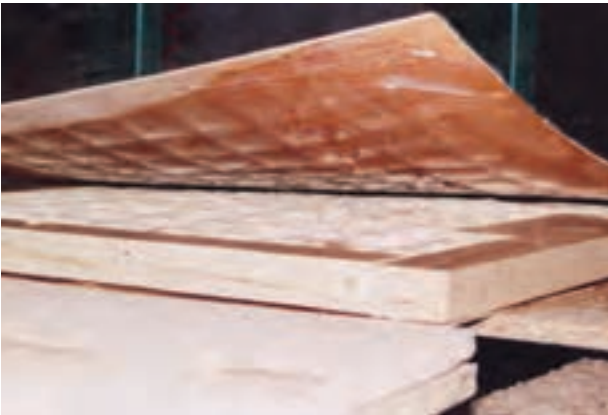
شکل ۱۱-۳۷- قرار دادن صفحه‌ی دوم، روی کلاف.
