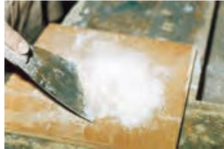
شکل ۴-۱۲- پودر مل و سریش را مخلوط کرده، در وسط تخته بتونه جمع کنید.
