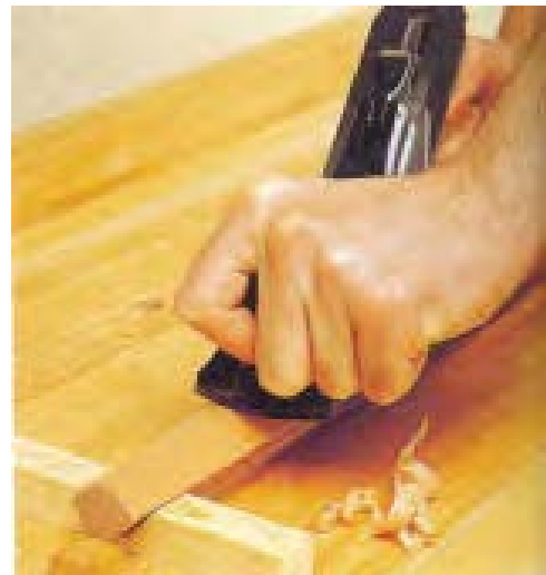
شکل ۲۷- نمونه‌ی پرداخت قید شش‌ضلعی با رنده پرداخت.
