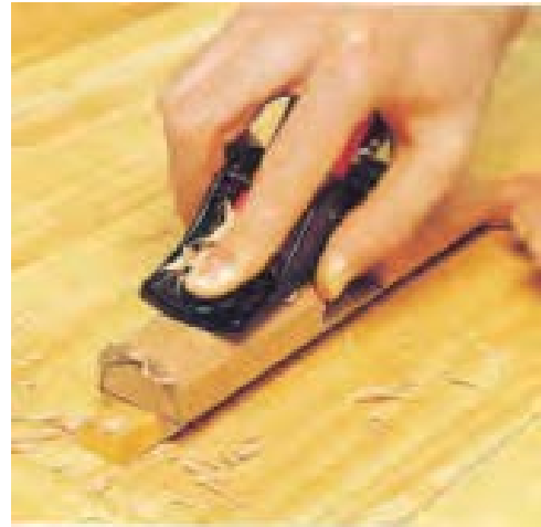
شکل ۲۶- نمونه‌ی پرداخت قطعه‌ای با مقطع نیمگرد.
