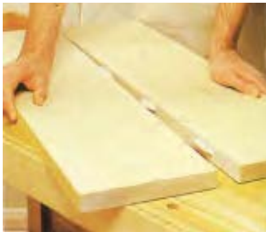
شکل ۹-۹۴- صفحه‌ی رویه، با اتصال بیسکویتی.
