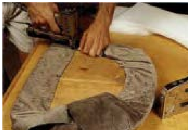
شکل ۸-۵- کاربرد منگنه در (ویه‌کوبی).
