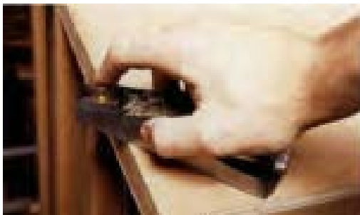
شکل ۱۹-۲- برای برطرف کردن لبه اضافی زهوار، باید رنده را کج هدایت کرد.
