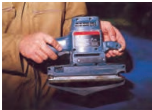
شکل ۷-۴۶- شل و سفت بستن سنباده شدن سنباده به دستگاه.
