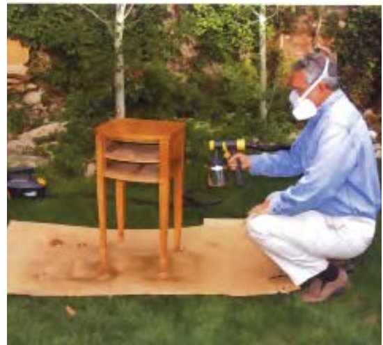
شکل ۲۳-۴. رنگ‌کاری با پیستوله (رنگ پوششی).
