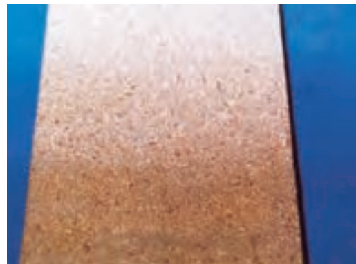
شکل ۴-۲- سطوح تخته فرده چوب، به دلیل فلل و فرج بسیار و شکل
