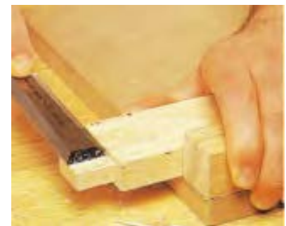
شکل ۹۸- اندازه کردن زبانه با مغار.
