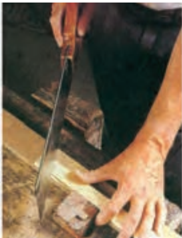
شکل ۱۱-۱۰- برش زهوار، با زاویه‌ی ۴۵ درجه.
