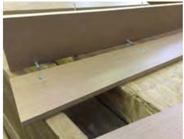
شکل ۱۲-۱۵- اتصال پایه‌ها به یکدیگر، با استفاده از اتصال الیت.
