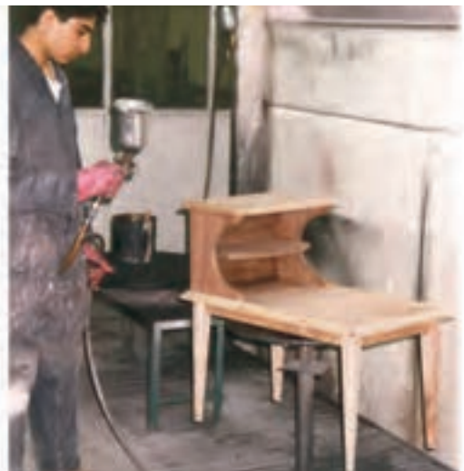
شکل ۲۴-۴. رنگ‌کاری با پیستوله (رنگ شفاف).
