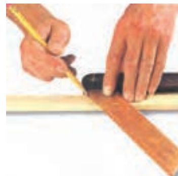
شکل ۱۰-۱۰- فطاکشی زهوار، با زاویه‌ی ۴۵ درجه.
