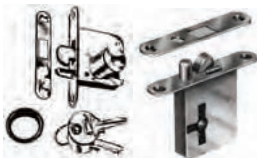
شکل ۱۰-۴۲-۱- قفل شاخ‌دار سوئیچی و کلیدی.
