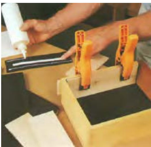
شکل ۱-۱۴۱- برای بستن قطعات نازک، باید از گیره‌ی انبری استفاده نمود.
