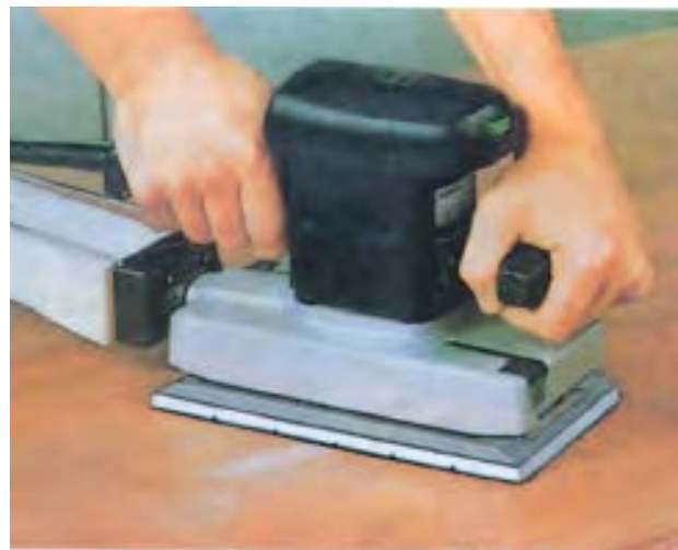
شکل ۳-۱۴- سنباده‌زنی با یک دستگاه سنباده لرزان کامل.
