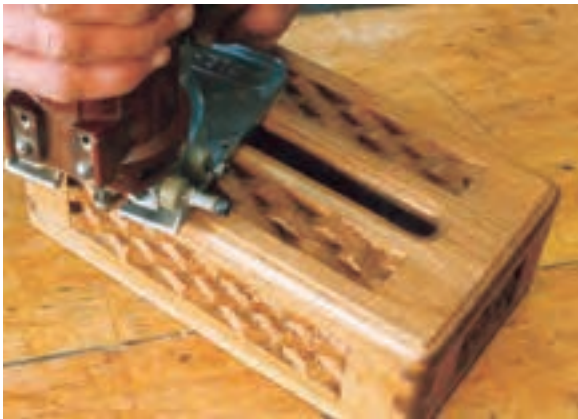
شکل ۹-۷۱- فرز کاری لبه‌های کار و شیار ممل فروج دستمال کاغذی.
