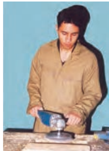
شکل ۷-۴۰- هدایت و کنترل صمغ دستگاه سنباده.
