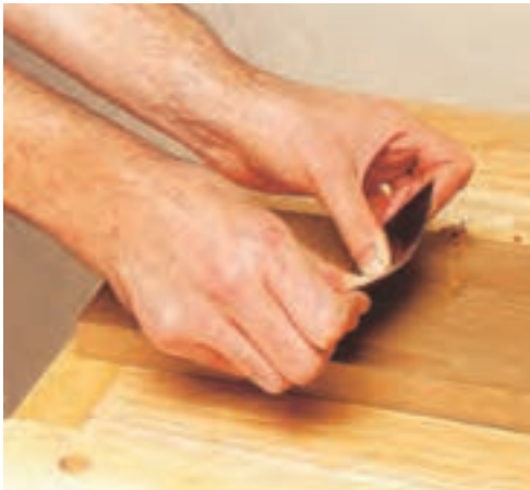
شکل ۲-۱۲- از فم کردن زیاد لیسه هنگام لیسه‌کاری مودداری شود.
