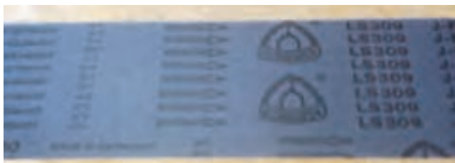
شکل ۷-۳۲- هنگام سوار کردن نوار سنبناده روی دستگاه، به جهت فلش‌ها و حرکت غلتک‌ها توجه کنید.
