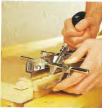
شکل ۱۰۰- شیار انداختن داخل قیده‌های عرضی.
