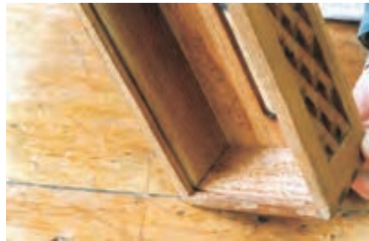
شکل ۹-۶۷- کنشکاف داخل بدنه‌های یک جعبه دستمال کاغذی.
