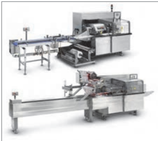
شکل ۱۳- نمونه‌ای از دستگاه‌های خط بسته‌بندی به روش اتمسفر اصلاح شده (MAP)
