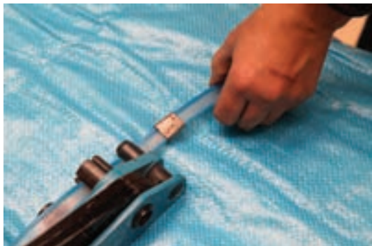
شکل ۸۶- قرار دادن بست فلزی روی نوار پلاستیکی
