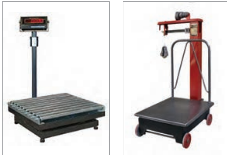
شکل ۳۱ و ۳۲- ترازوی باسکولی مکانیکی و باسکول دیجیتالی
