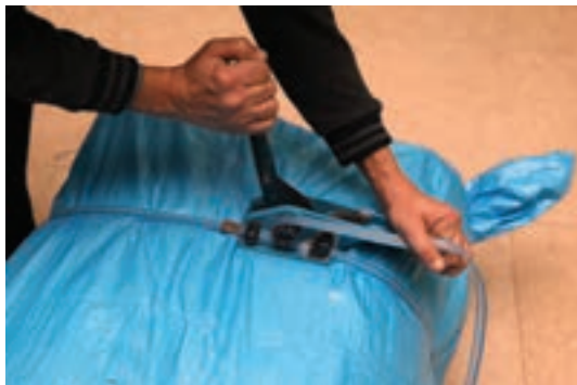
شکل ۸۵- کشیدن نوار به کمک ابزار نوارکش
