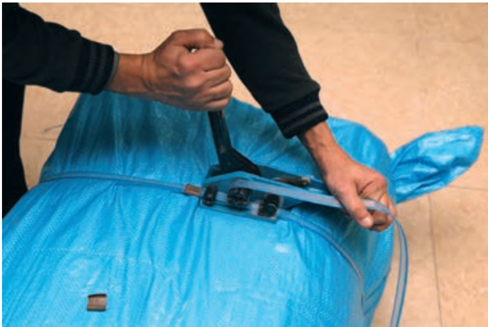
شکل ۲۲- نوارکشی روی بسته با نوار پلاستیکی
