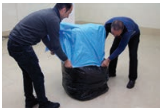
شکل ۷۶ و ۷۷- روش کشیدن گونی روی بسته‌های فرش
