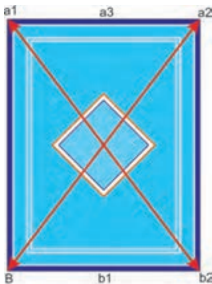
شکل ۶۴- اندازه گیری قطرهای فرش
