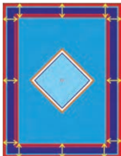
شکل ۶۵- اندازه گیری پهنای حاشیه در نقاط مختلف از یک فرش
