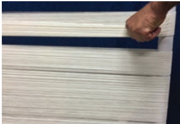
شکل ۳۰-۲- تنظیم تارها بر روی میله
