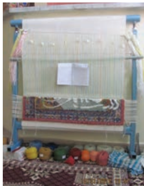
شکل ۱۰-۱- زیر دار ثابت و سردار متحرک (مدل ۲)
