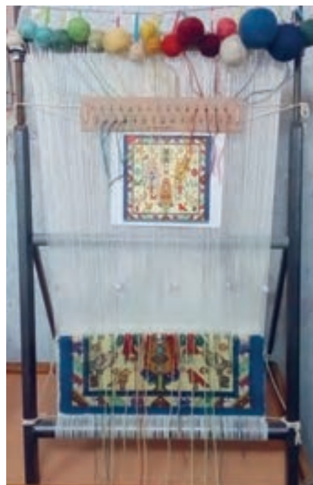
شکل ۹-۱- زیر دار ثابت و سردار متحرک (مدل ۱)
