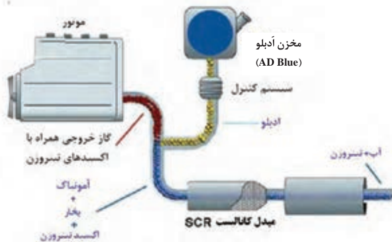
شکل شماره ۲۸- سیستم کاتالیست کاهش دهنده آلاینده‌ها (SCR)
