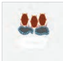
جذب ذرات قیر به سطح سنگ دانه ها
