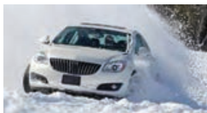
شکل ۲- کاهش اصطکاک بین تایر و برف موجب بکسواد تایر می گردد
