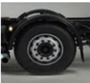
شکل ۳- موقعیت نصب گلگیر و باران گیر
