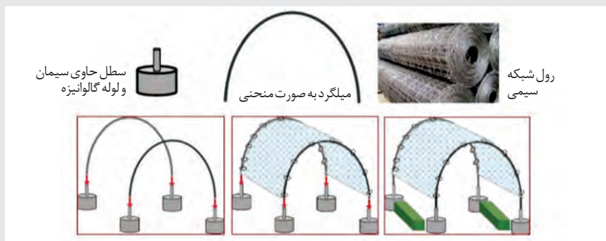
مراحل ساخت تونل سبز توسط شبکه‌های سیمی
