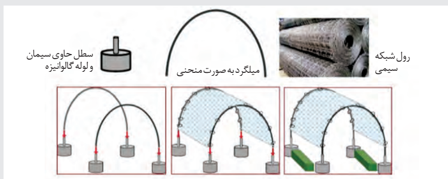
مراحل ساخت تونل سبز توسط شبکه‌های سیمی
