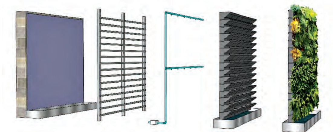
نحوه اتصال گلدان‌های کاشت روی شبکه‌های فلزی
